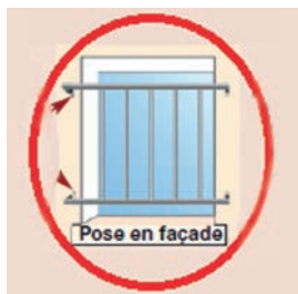
Pose en façade
